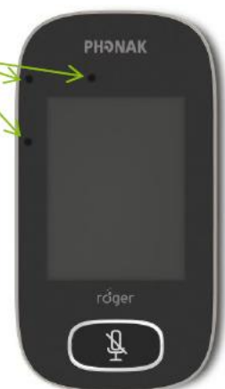
図3：RTMの表面にある3つの無指向性マイクの配列
