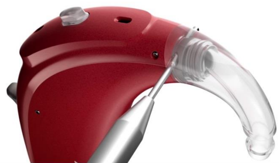
図 6. イヤフックのロックを解除するツール
