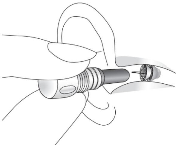
**Etapa 2:** Desenrosque a tampa do ímã para expor a ferramenta de remoção. Com a mão apoiada na bochecha, segure firme a ferramenta de remoção, da mesma forma que você segura um lápis. Insira a ferramenta de remoção lenta e cuidadosamente no canal auditivo até tocar ligeiramente no aparelho auditivo.
