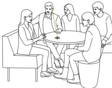
로저 송신기는 전방향 송신기를 활성화합니다. 화자가 말하면 로저 송신기가 송신기 초점을 화자에게 맞추고 배경 소음을 줄입니다.
